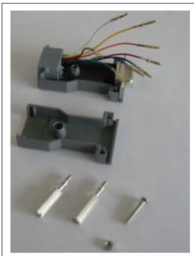
Die losen Pins werden in die entsprechende Öffnung des Sub-D Steckers gesteckt.
